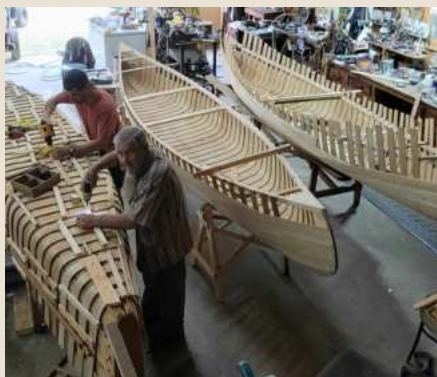
La construction des canots a débutée en juillet 2024 avec Rodrigue Pelchat à Saint-Félicien.
